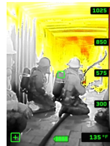
FIRE Käytössä TI BASIC+ (pistelämpötilalukemalla)
